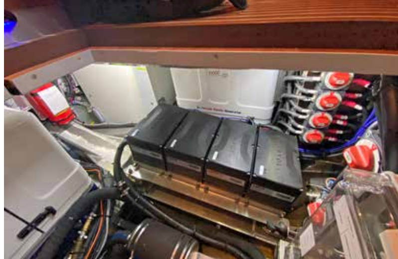
Een Garcia Exploration uitgerust met een serie-hybride systeem waarbij dieselgeneratoren het elektrisch vermogen voor de elektromotor leveren.
